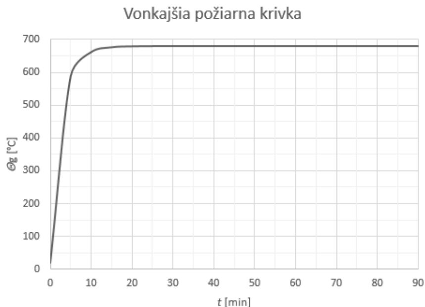
Obrázok 4: Vonkajšia požiarne krivka podľa STN EN 1991-1-2
